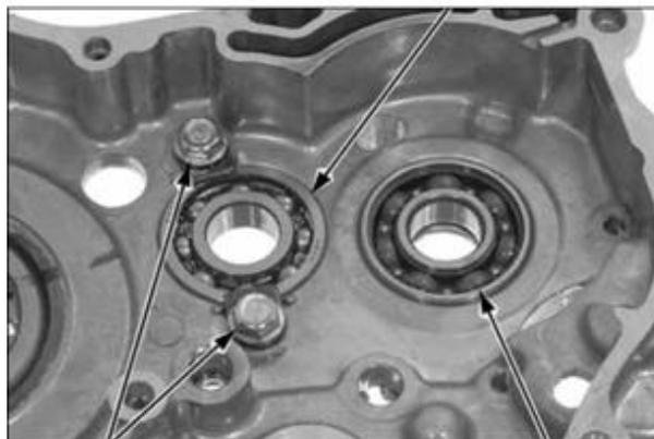
2. Retirer le roulement du demi-quartier de droite à l'aide d'un extracteur de roulement.
