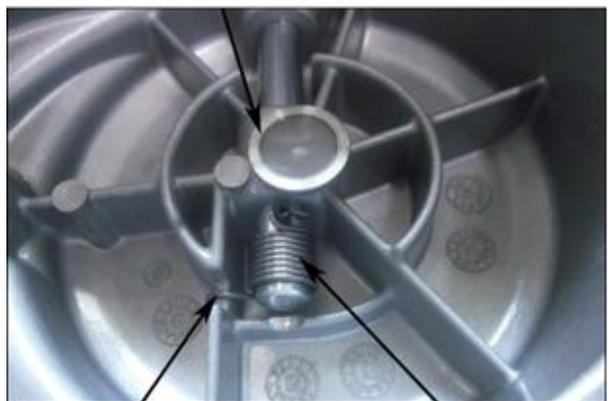
2. Utilisez des outils pour retirer la clavette du levier d'embrayage et retirez le ressort.
