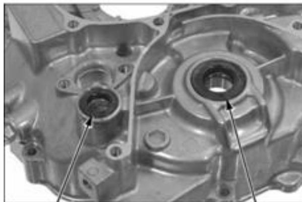
4. Retirez les roulements du demi-quartier de gauche à l'aide d'un extracteur de roulement.
