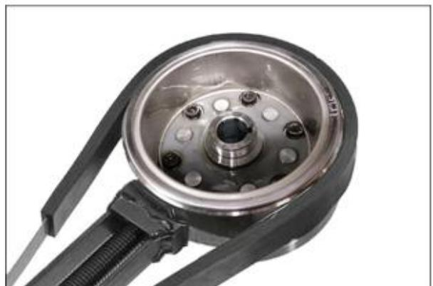
9) Monter la couronne de lanceur sur le volant magnétique et tournez-la dans le sens inverse des aiguilles d'un horloge. La couronne doit être correctement recouverte d'huile de graissage. Assurez-vous que la couronne peut pivoter librement mais ne peut pas pivoter dans le sens opposé.
