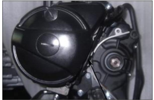
2. Desserrez les vis de fixation et retirez le couvercle gauche.
