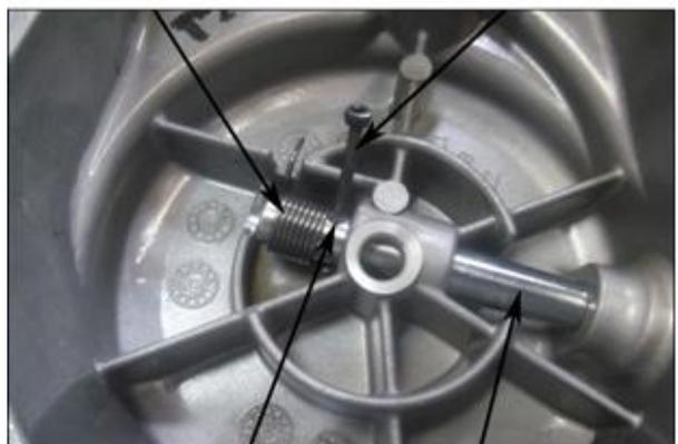
3. Retirer le levier d'embrayage et le joint spi.
