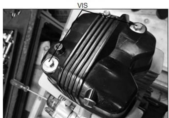
2. Retirez le couvercle supérieur de la culasse et le joint d'étanchéité correspondant.
