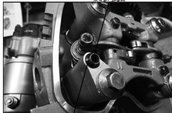
4. Retirez la vis et la rondelle de pression d'huile du couvercle de la culasse.
