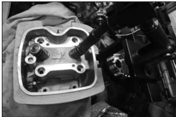
4. Installez la goupille de guidage et remplacez le joint de culasse par un neuf.
