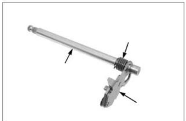
4. Monter le levier d'arrêt, le ressort, la vis et la rondelle. Le crochet à ressort doit s'insérer dans la place de la plaque de positionnement.
