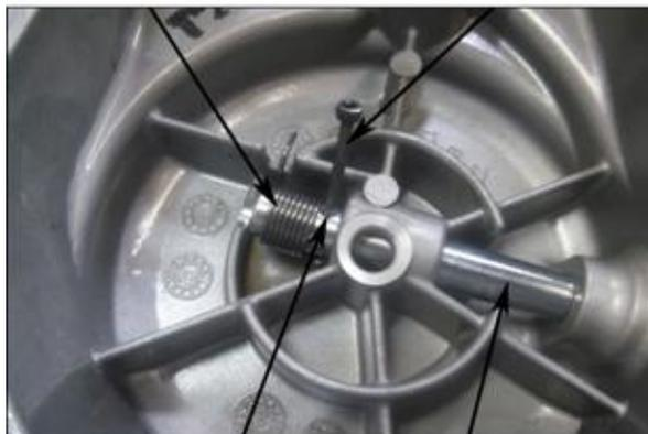
3. Tourner le bras du levier d'embrayage lorsque le ressort se trouve dans la position indiquée dans l'image, puis installer la tige de poussée.
