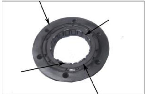
7) Installer l'embrayage de démarrage dans le rotor.
