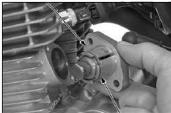
4. Serrer la vis, utiliser des outils pour ajuster le tendeur jusqu'à ce qu'il soit serré.
