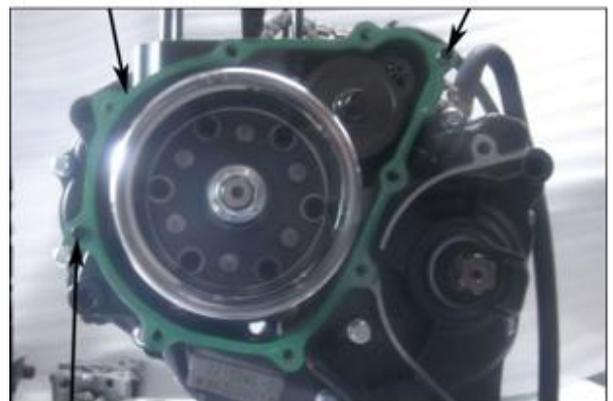
4. Placez le couvercle gauche et serrez les vis de fixation selon la séquence indiquée.
