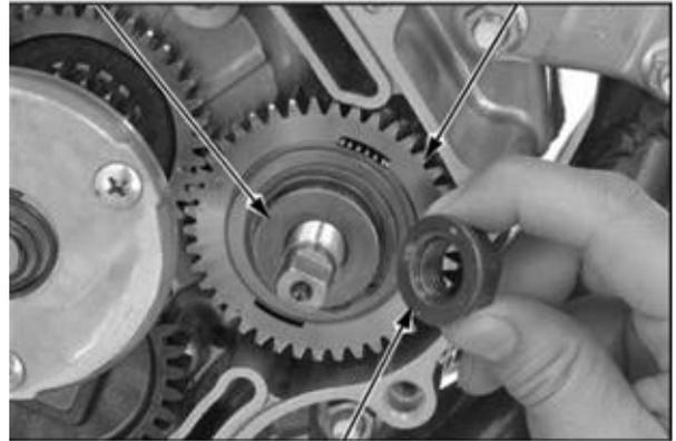
2. Retirez la clavette et le roulement de l'arbre d'équilibrage.
