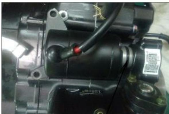
10. Installer le démarreur et les vis de sécurité.
