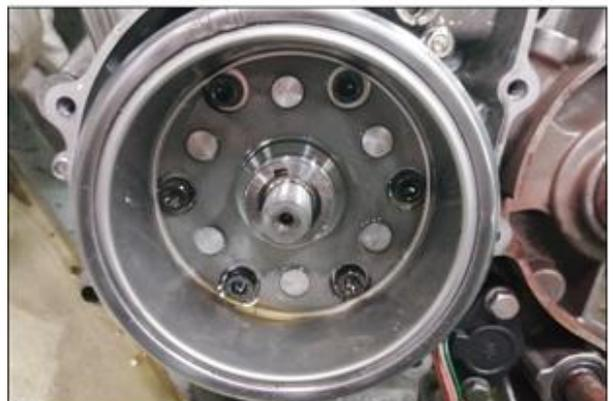
7. Insérer l'écrou de fixation en fonction du couple de serrage spécifié.
