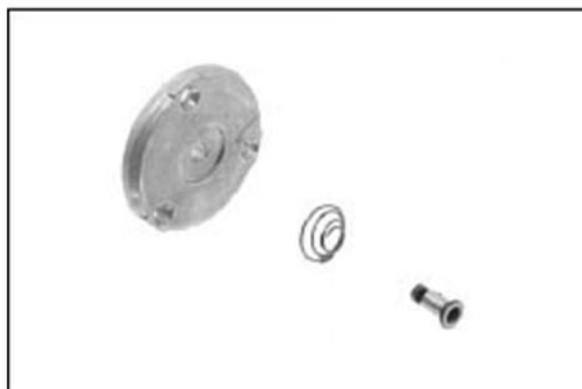
8. Monter la goupille, le tube de sortie et le ressort du filtre à huile.
