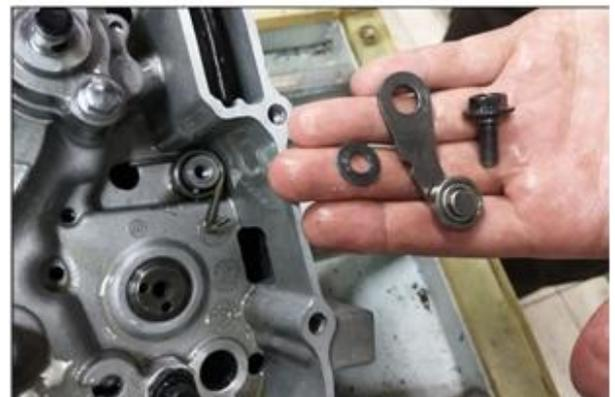
5. Après avoir déplacé la plaque de positionnement avec un tournevis plat, montez la goupille et la plaque en forme d'étoile
