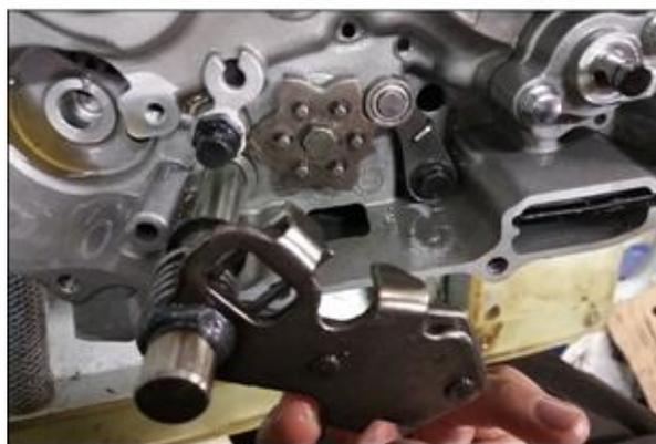
8. Insérer le ressort de rappel de l'arbre du sélecteur dans le levier d'arrêt. Tourner l'arbre de sélection pour vérifier qu'il est installé dans sa position.
