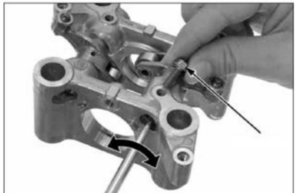
4. Après avoir vérifié que les vis sont correctement installés, utilisez un outil de serrage pour serrer les vis au couple spécifié.
