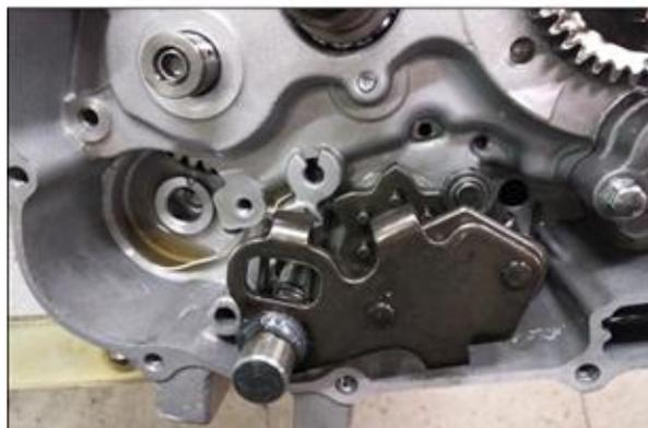
1. Retirer la vis de la plaque en forme d'étoile, puis retirer la plaque.
