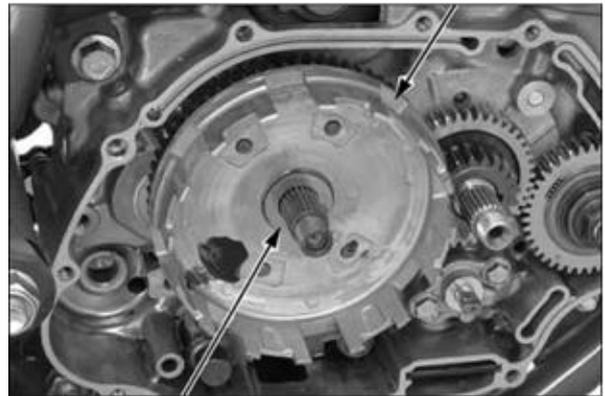
3. Appliquez la quantité appropriée d'huile de lubrification sur les pignons. Installez la cloche d'embrayage et la rondelle.
