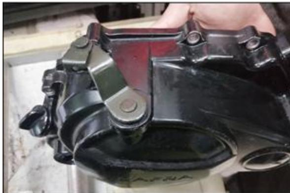
4. Vérifiez que la came d'embrayage pour détecter possibles déformations. Vérifiez si la barre de poussée est endommagée et si nécessaire, remplacez-la.
