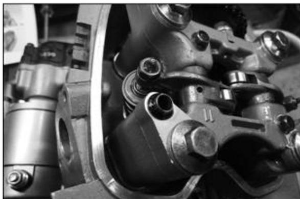
8. Remplacer le joint et monter le couvercle supérieur sur la culasse
