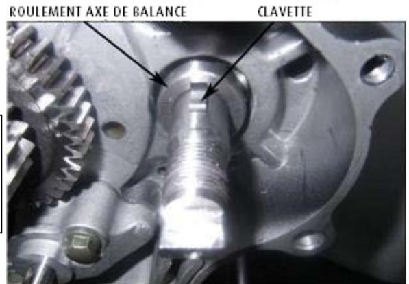
2. Aligned la rainure de clavette du pignon de commande avec la clavette sur l'axe de balance. Tourner le pignon de commande pour aligner la rainure de clavette avec la marque de de position de calage.
