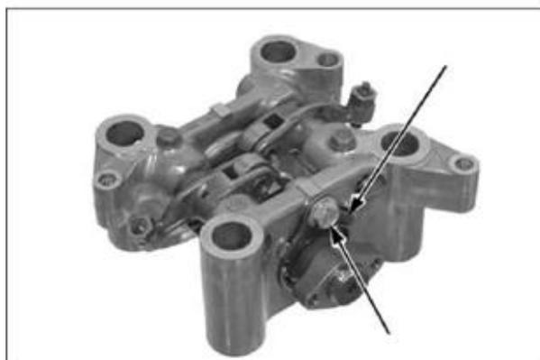
8. Installez le culbuteur complet sur la culasse. Il faut prendre soin de vérifier si les deux broches de guidage sont en bon état avant le montage.
