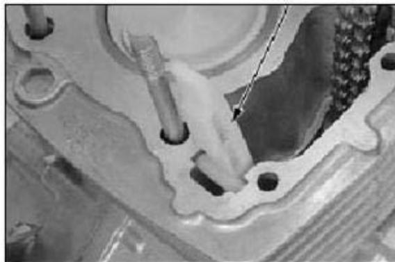
2. Tapez le cylindre avec un marteau en caoutchouc pour séparer le cylindre du carter. Tirez le cylindre vers le haut. Il faut surveiller à ne pas endommager le piston lors du démontage du cylindre.
