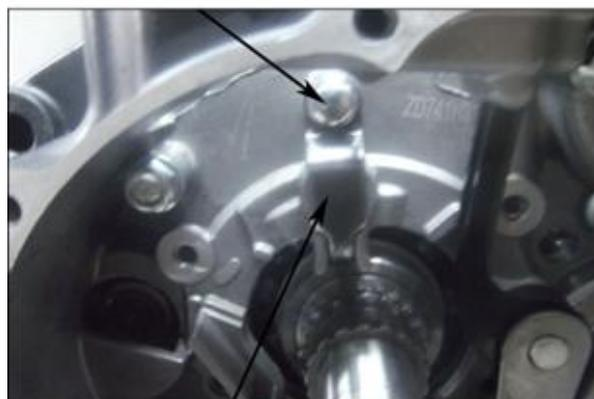
11. Assembler la chaîne, la plaque de tension, la plaque de protection et serrez les vis selon le couple de serrage spécifié.
