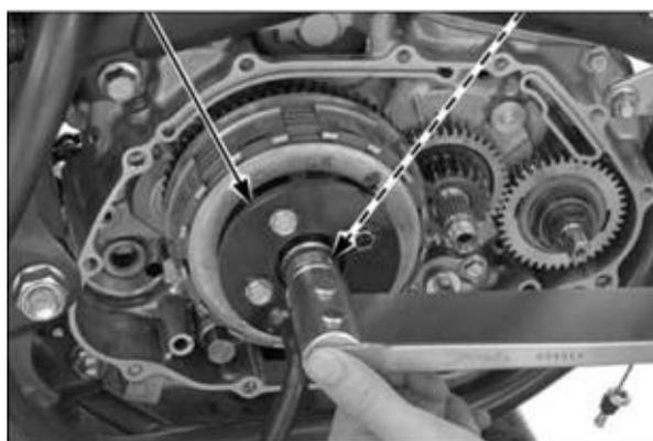
7. Monter les ressorts et la plaque d'embrayage, serrez les vis du support pour étapes.
