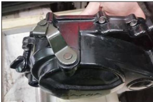
2. Utilisez des outils pour monter la clavette du levier d'embrayage et retirez le ressort.
