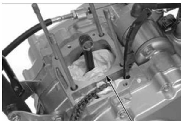
Nettoyez le joint en papier, l'huile et les autres corps étrangers de la surface de contact entre le carter de vilebrequin et le cylindre avant d'assembler le cylindre et le piston.
