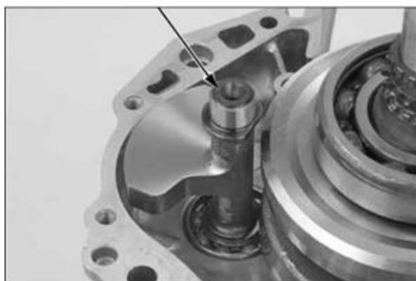
3. Nettoyer les zones d'assemblage des moitiés droite et gauche du carter. Appliquez l'adhésif de scellement sur la surface de contact de la moitié gauche, comme indiqué sur la figure.
