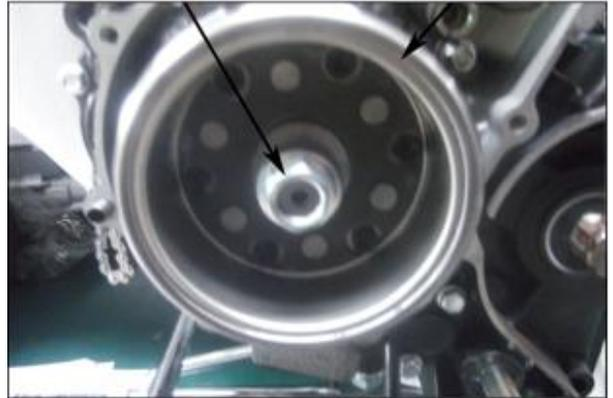
5. Démontez et vérifiez l'état du roulement à aiguilles et de la clavette de vilebrequin.
