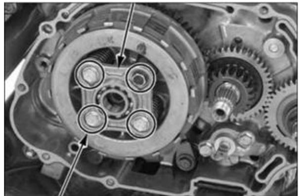
2. Enlever l'écrou et la rondelle d'embrayage
